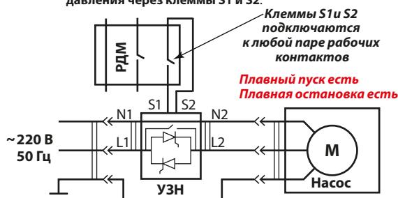
Схема управления УЗН через поплавковый выключатель
